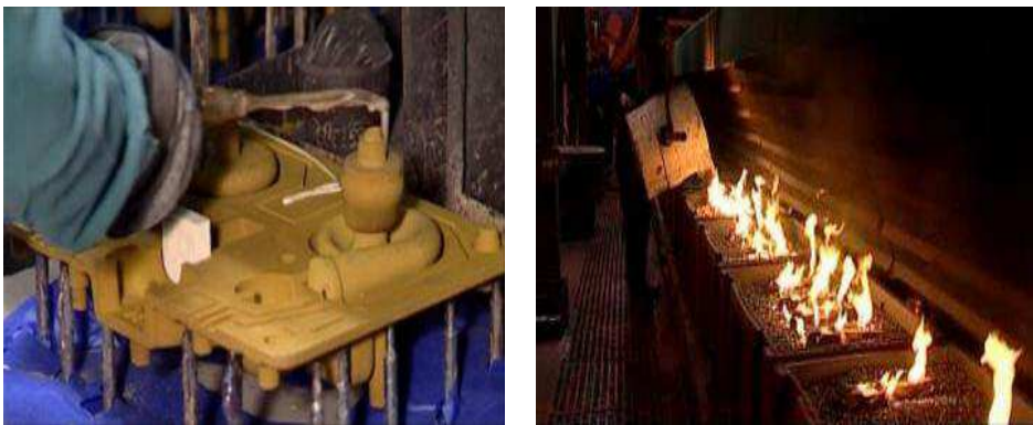
Obr. 2.21: Jadrá vytvorené metódou „Croning“
