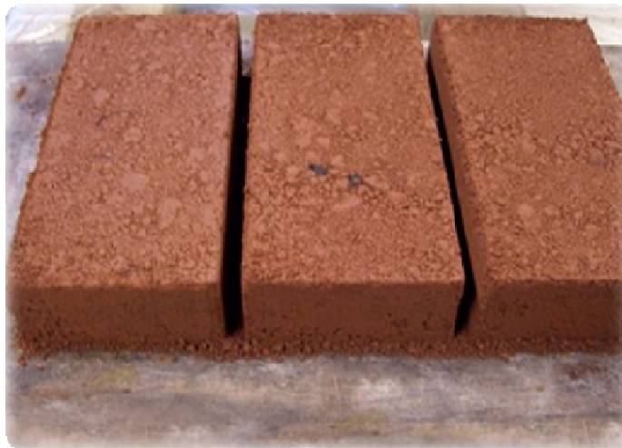
Obr. 5.10: Tehly z obsahom červeného kalu
