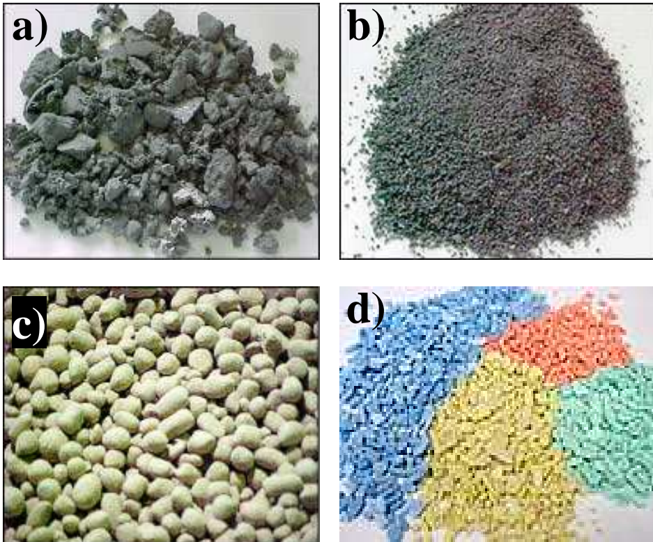
Obr. 5.25: Produkty zo sterov: a) Recyklovaný koncentrát pre tavenie; b) Prášok (deox); c) NMP; d) recyklovaná soľ – granulát (Promet, CZ)
