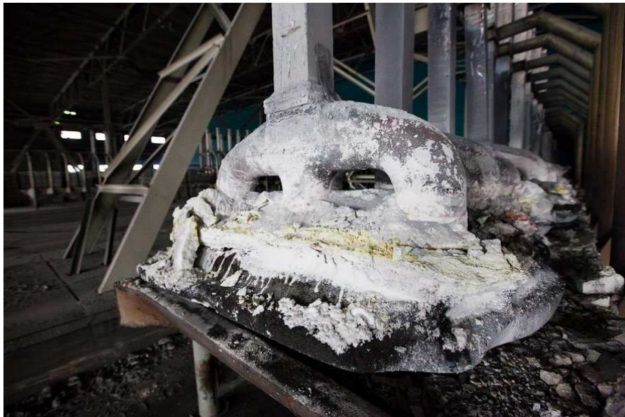
Obr. 5.13: Anódový zvyšok z elektrolýzy
