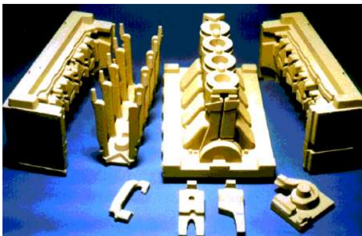
Obr. 2.22: Chemicky viazané jadrá hláv valcov, ukážky foriem a jadier
