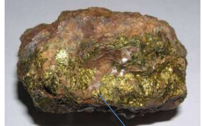
Ruda s obsahom chalkopyritu. Chalkopyrit je minerál Cu ( \text{CuFeS}_2 )
